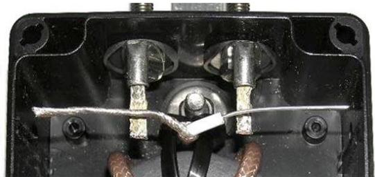
Danach entnimmt man den umwickelten Kern und lötet die Kabelschuhe an die zugeschnittenen Enden.
