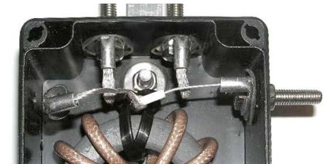
Nachdem die Koaxseele und der Gewebeschild mit den angelöteten Kabelschuhen an den seitlichen Schrauben des Gehäuses befestigt wurden, müssen nun die beiden freien Gewebeschild-Enden der oberen Kabelschuhe (für „Top Wires“ 10m & 12m) von unten um den jeweiligen Querleiter gefaltet, der Überstand abgeschnitten und sauber angelötet werden. Damit entstehen diese stabilen Verbindungen (im Bild rechts).
