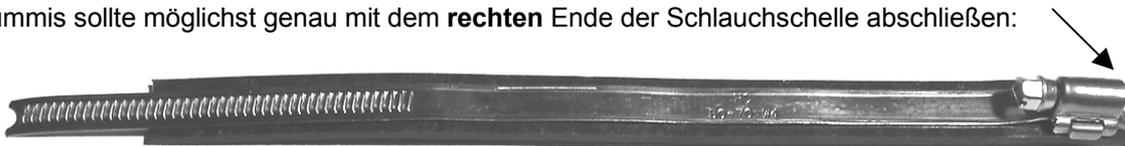
Dann schiebt man den Schrumpfschlauch darüber. Das **linke** Ende des Schrumpfschlauches sollte möglichst genau mit dem **linken** Ende des Gummis abschließen:
