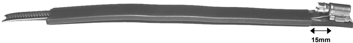
Wie im Foto zu erkennen, sollte das rechte Ende des Schrumpfschlauchs ca. 15mm vom Schraubengehäuse entfernt sein.
