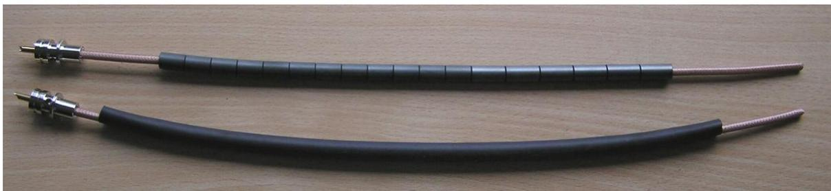
6. 35cm des Schrumpfschlauches 9/3mm abschneiden.
