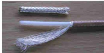
2. Die verbliebene Abschirmung mit einem spitzen Werkzeug öffnen, auf 10mm kürzen und nach hinten biegen.
