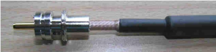
11. Beidseitig den Schrumpfschlauch auf das dünne Ende des PL-Steckers schieben und mit dem Heizlüfter einschrumpfen.
